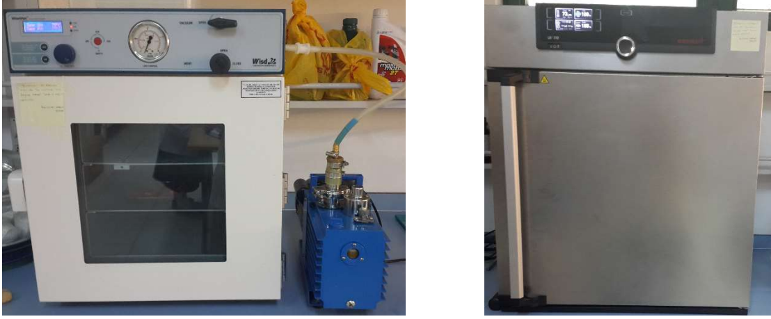
Şekil 3.2 Vakum kurutma sistemi (sol) ve kabin kurutma sistemi (sağ)
