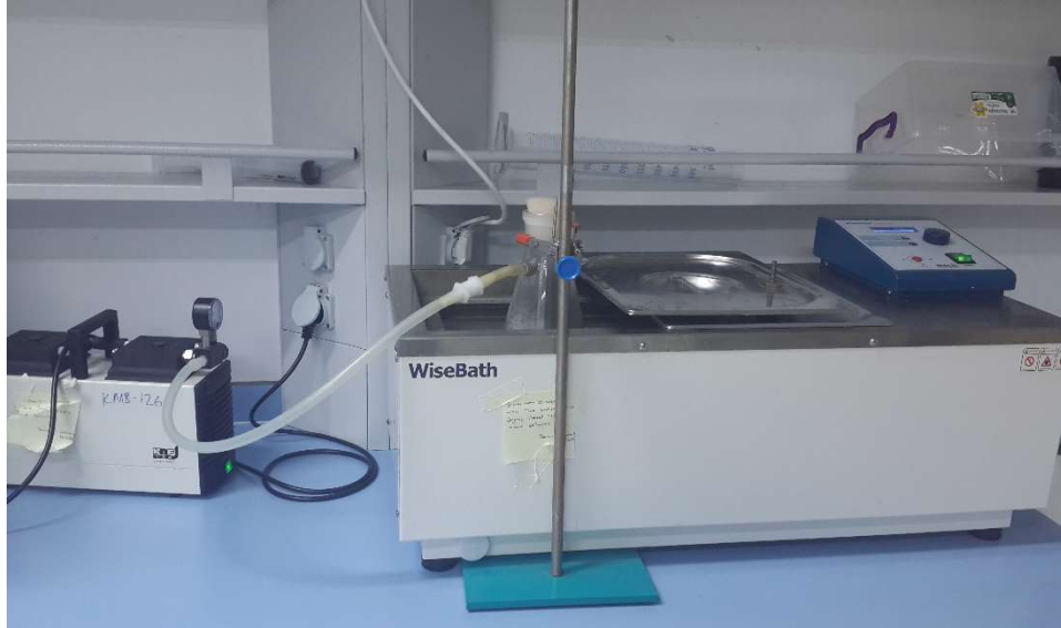
Şekil 3.4 Ultrason destekli vakum kurutmanın kontrol sistemi
