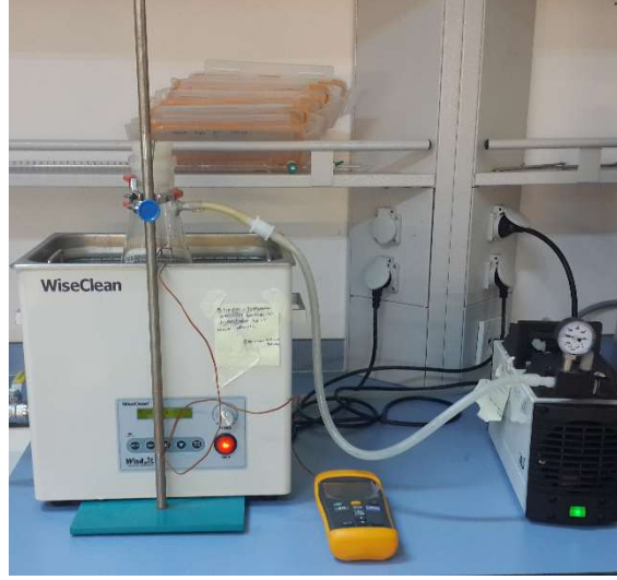
Şekil 3.3 Ultrason destekli vakum kurutma sistemi
