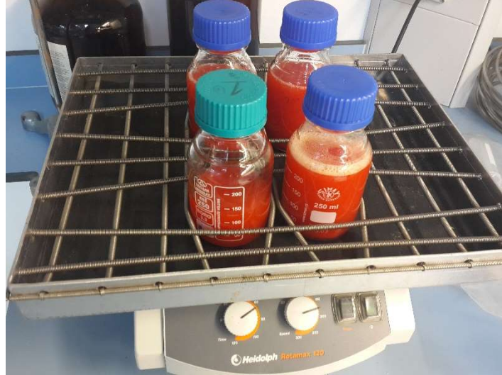
Şekil 3.6 Homojen çözeltilerin 2 saat boyunca oda sıcaklığında çalkalanarak inkübasyona bırakılması
